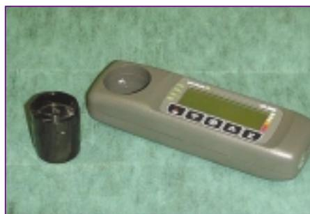
Fig. 4. Espirómetro de turbina con el cabezal desmontado para su limpieza.
