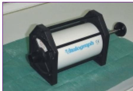
Fig. 2. Jeringa de calibración de un litro.
