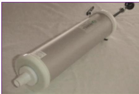
Fig. 1. Jeringa de calibración de tres litros. Este modelo concreto lleva un pistón graduado con un tope que permite variar el volumen introducido.
