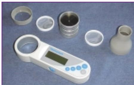
Fig. 3. Neumotacógrafo completamente desmontado para la limpieza de sus partes. La pieza del centro es el cabezal de tipo Fleisch.
