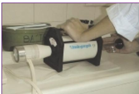
Fig. 3. Maniobra de calibración de un neumotacógrafo.
