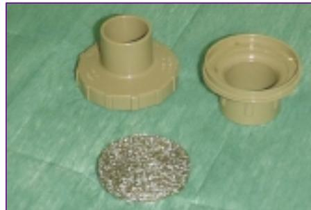
Fig. 2. Filtro semidesechable desmontado.
